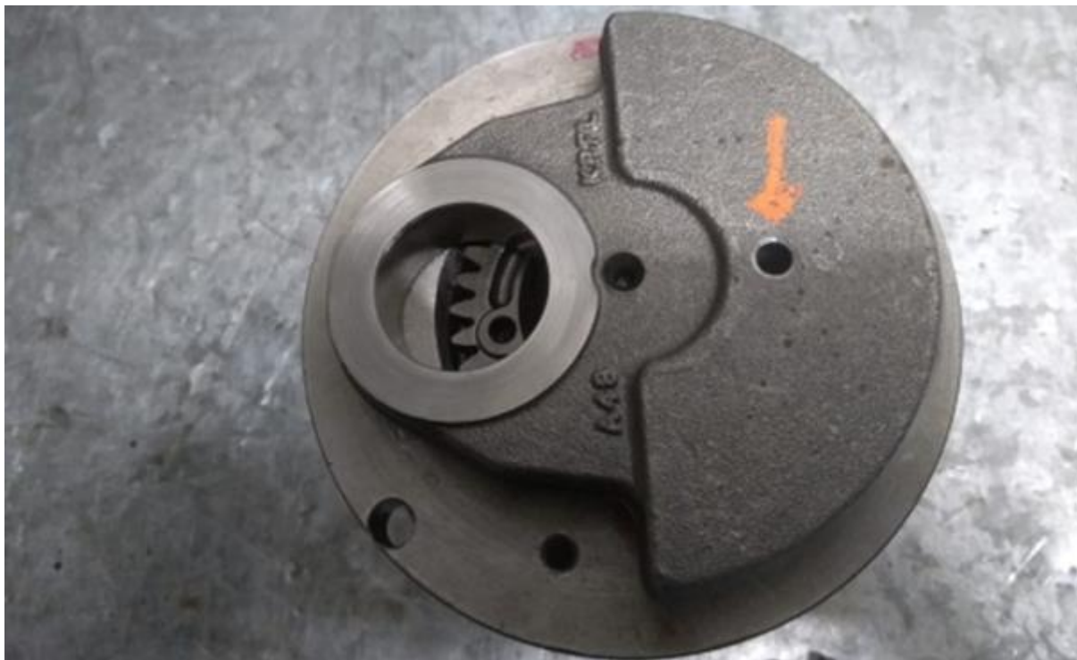
Imagem 5 - detalhe do furo na bolacha do virabrequim
