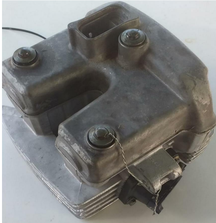
Imagem 2 – Detalhe furo passante no parafuso do cabeçote
