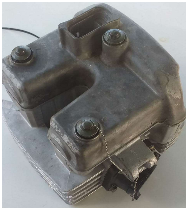
Imagem 3 – Detalhe furo passante no parafuso do cabeçote
