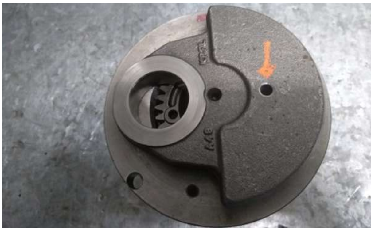
Imagem 6 - detalhe do furo na bolacha do virabrequim
