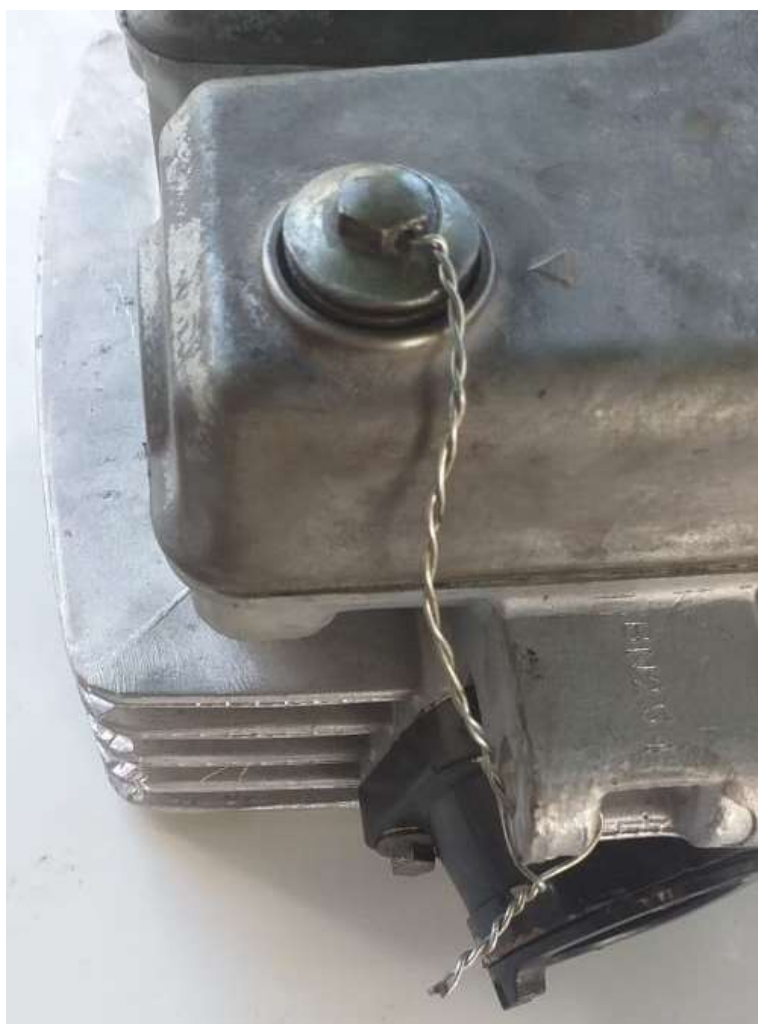
Imagem 4 – Detalhe furo passante no parafuso do cabeçote
