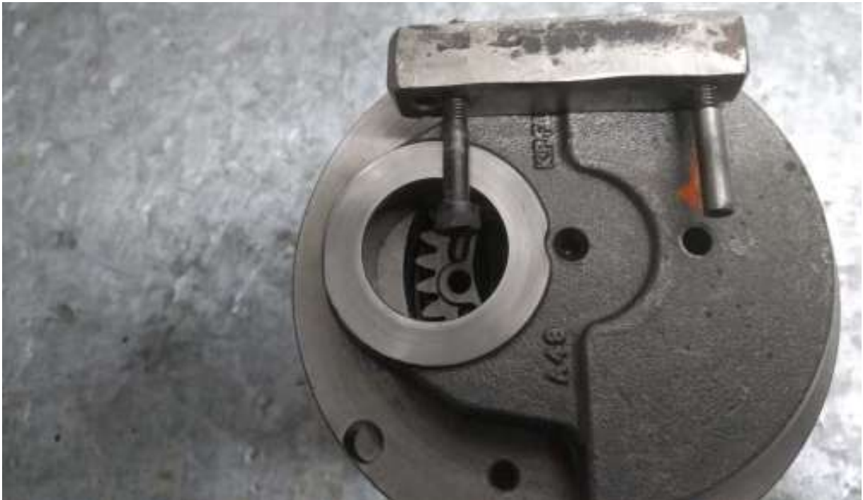
Imagem 7 – detalhe do furo na bolacha do virabrequim com ferramenta de saque
