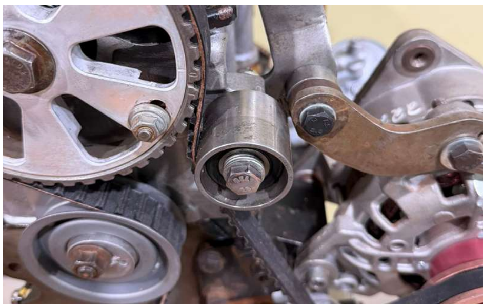
Imagem 11A – ilustração do rolamento de encosto da correia dentada.
