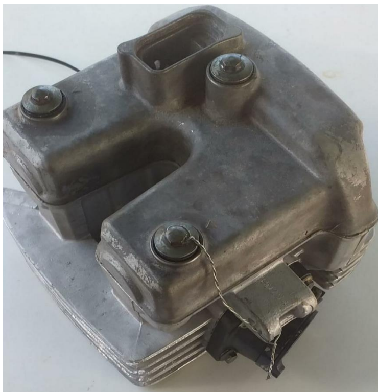
Imagem 2 – Detalhe furo passante no parafuso do cabeçote
