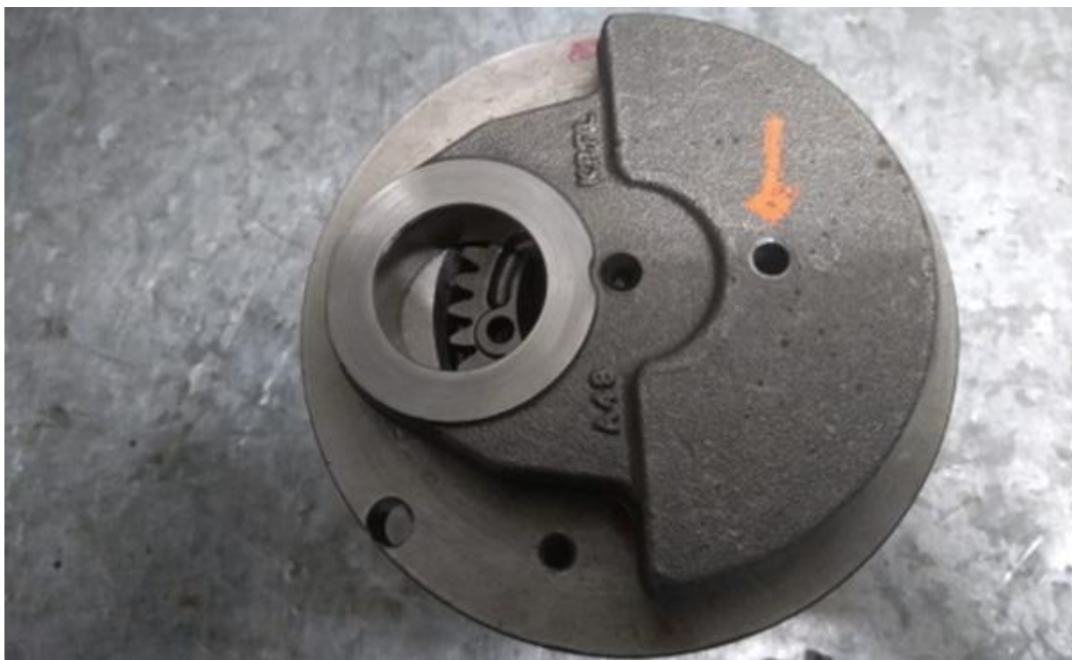
Imagem 5 - detalhe do furo na bolacha do virabrequim
